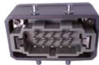
■ Plugue de Energia / Termopar completo MACHO de 10 pinos, 2 linhas (inclui prensacabo, miolo macho e carcaça de "2 travas")
