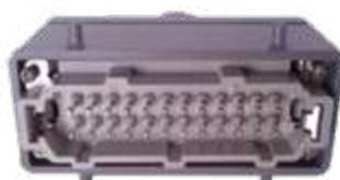
■ Plugue de Energia / Termopar completo MACHO de 24 pinos, 2 linhas (inclui prensacabo, miolo macho e carcaça de "2 travas")
