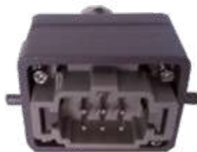
■ Plugue de Energia / Termopar completo MACHO de 6 pinos, 2 linhas (inclui prensacabo, miolo macho e carcaça de "1 trava")
