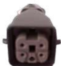
■ Plugue de Energia / Termopar completo FÊMEA de 5 pinos, 2 linhas (inclui prensacabo, miolo fêmea e carcaça de "1 trava")
